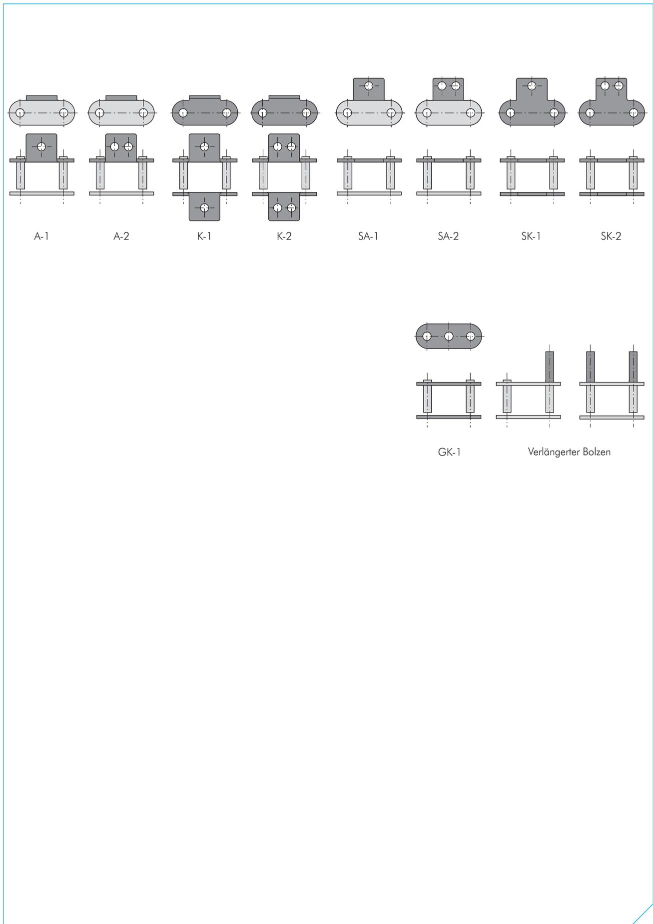
Abb. 4 Typenübersicht langgliedrige Ketten mit Anbauteilen
