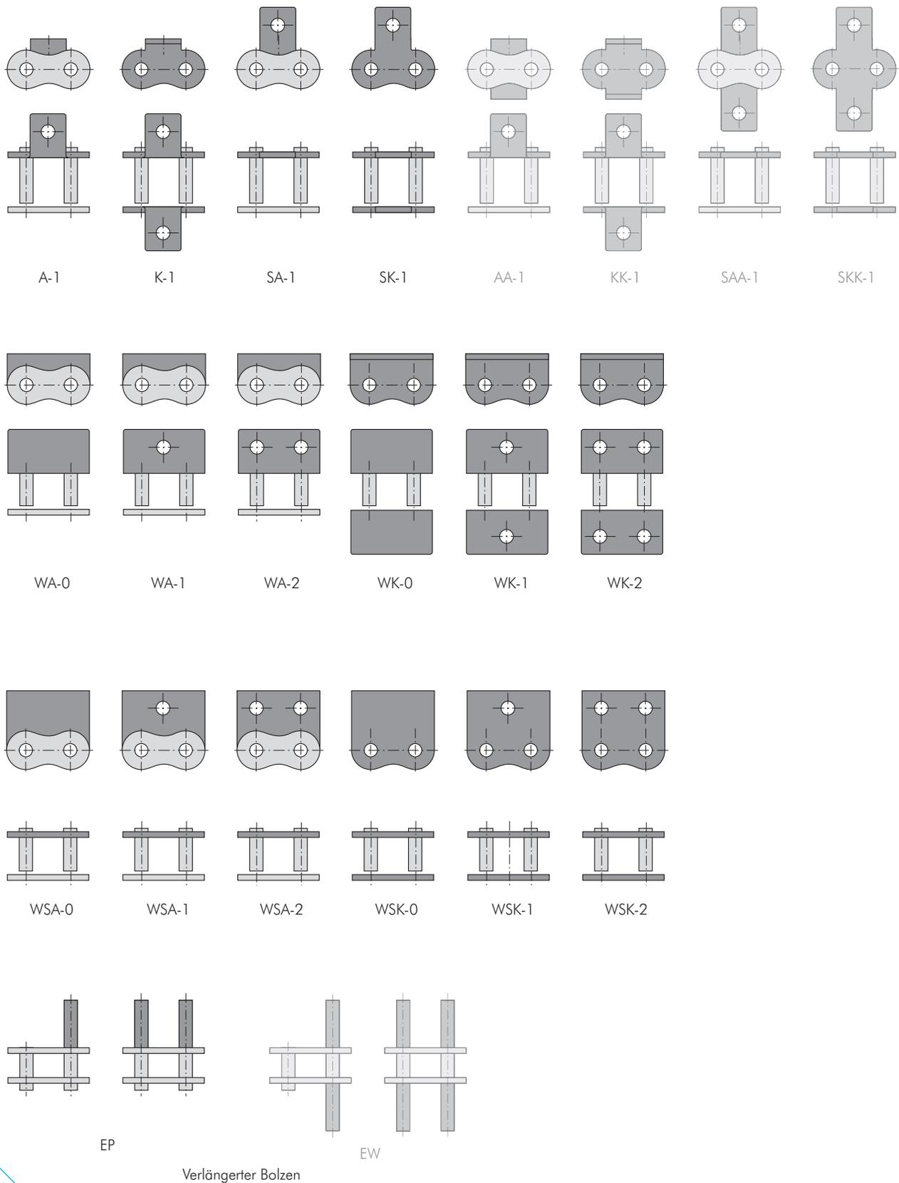
Abb. 3 Typenübersicht kurzgliedrige Ketten mit Anbauteilen
